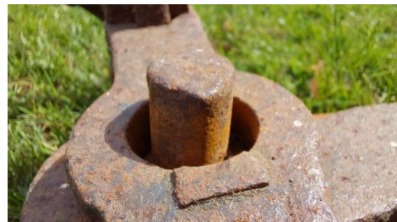
As van het juk van een waag uit 1707. De punt van de as is gemaakt van gehard staal en draait op een zo klein mogelijk oppervlak voor de minste wrijving.
